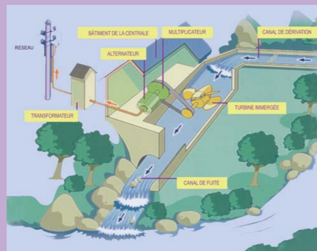
Principe de fonctionnement d'une centrale hydroélectrique
